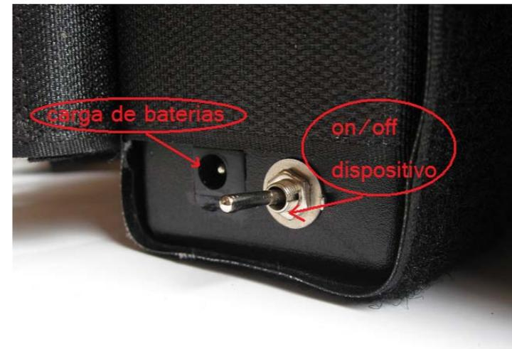
Adicionalmente tiene 2 interruptores, uno para el encendido del dispositivo y otro para el encendido del modulo LCD; y una perilla para el ajuste de contraste en el LCD.
