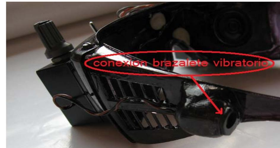
Módulo No. 2 Módulo Gafas: Ubicado en la cabeza. Posee una conexión con terminal serial en el lado derecho inferior, que se conecta con el modulo fisioterapeuta mediante un cable.
